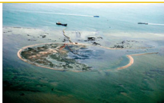
Figuur 2 proefsuppletie Galgeplaat, links: locatie, rechts: overzicht. De lichtgekleurde ring is een voorafgaand aan de suppletie opgeworpen zandkade (diameter 500 m) om wegglekken van het materiaal tijdens de suppletie te voorkomen. (Foto: https://beeldbank.rws.nl/ )
